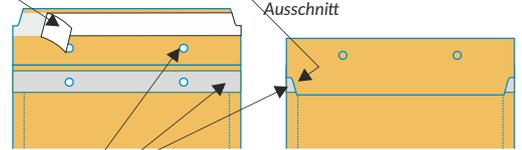
**Prüfstreife** – verwendet zwecks der Inhaltskontrolle nach dem Verpacken vor dem Versand; ermöglicht die Verschlussklappe abzulösen, ohne Beschädigung der Klappe und des Leims
